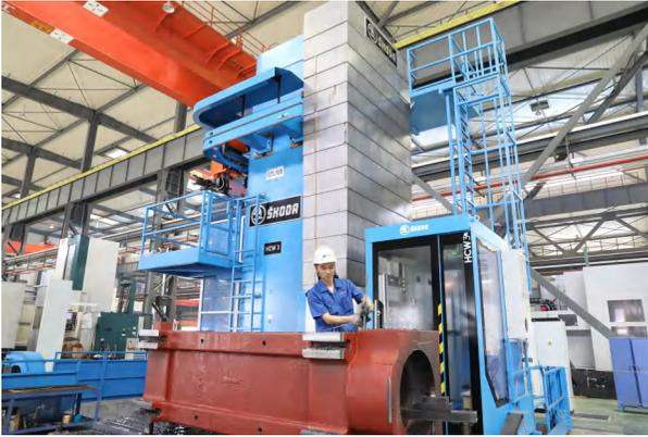
挤出机注射座加工
